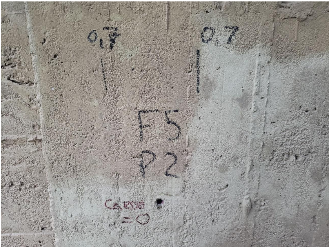
Figure 62: Ensaio de carbonatação - Carbonatação = 0cm
